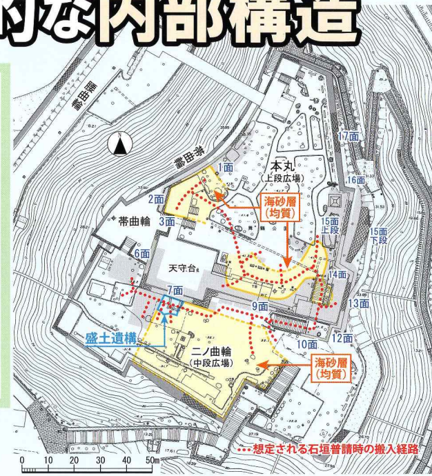
海砂層（均質）造成範囲分布図 普請工程の最後に造成された均質な海砂層の分布範囲から、石垣普請時の搬入経路（赤色破線）が想定される。
